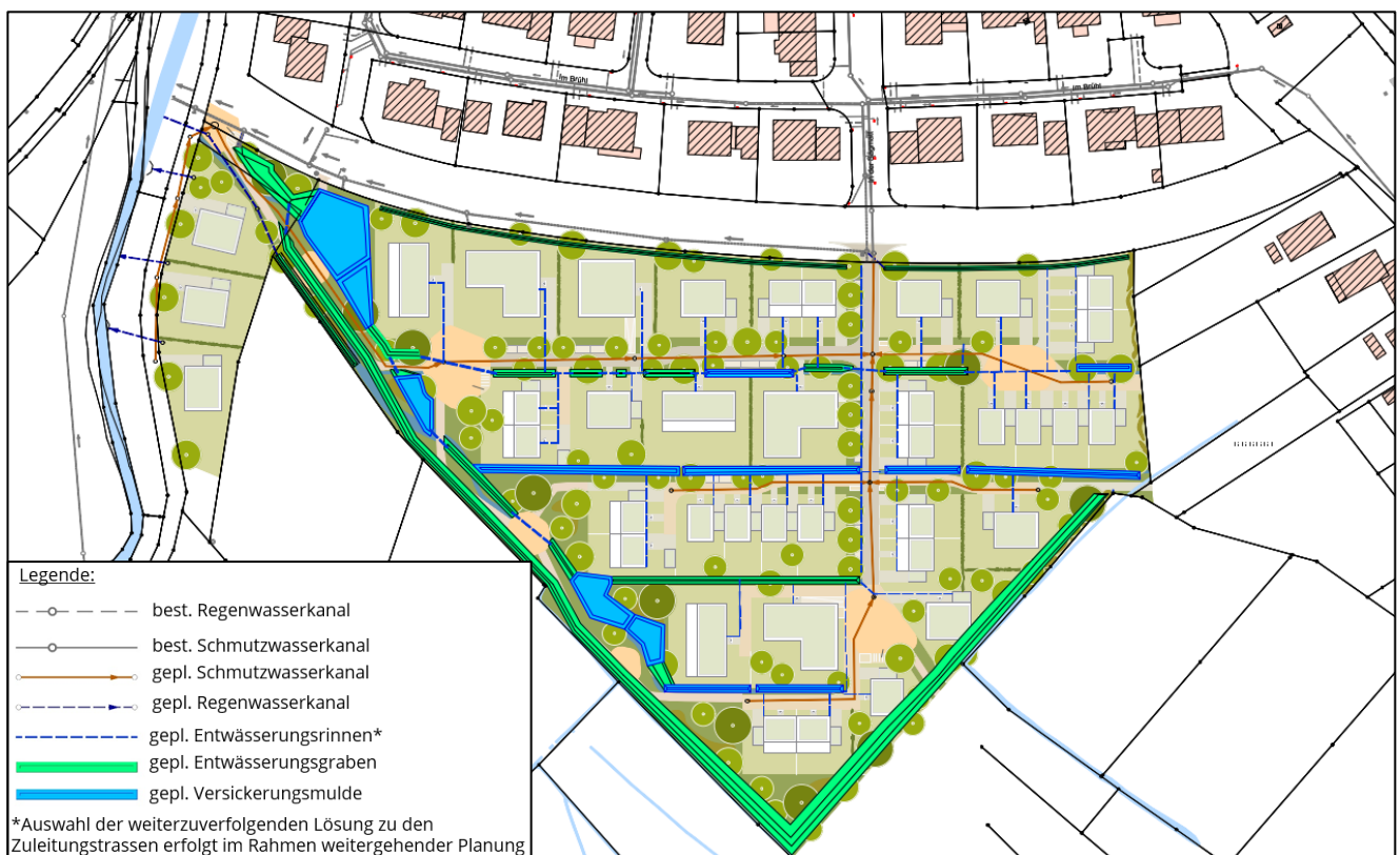
Abbildung 3.1 Schematische Darstellung der Variante 1 des Entwässerungskonzeptes – Entwässerung mittels oberflächennahen Ableitwegen
