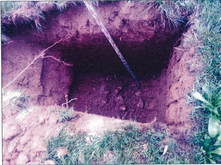
Abb. 11: Baggergut aus Schurf S 6, stark sandiger, schluffiger Auelehm, kiesführend
