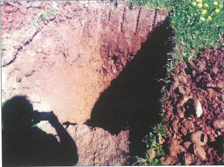
Abb. 8: Baggergut aus Schurf S 5 , stark sandiger, schluffiger Auelehm
