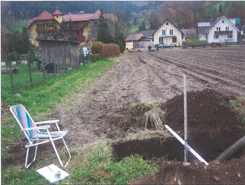
Abb. 5: Versuch VV 2 vor der ersten Befüllung, Schurfsohle im Bereich der Kinzig- schotter
