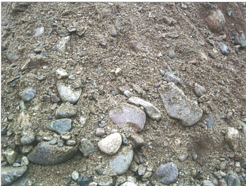
Abb. 9: Baggergut aus Schurf S 2, sandige Kinzigschotter mit Grobkies und Steinen durchsetzt
