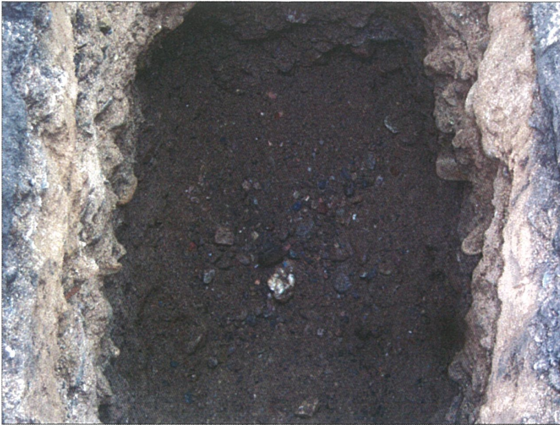
Abb. 8: Schurf S2, Kinzigschotter mit bei der Ablagerung gut eingeregeltten Grobkomponenten, Korn-zu-Korn-Abstützung
