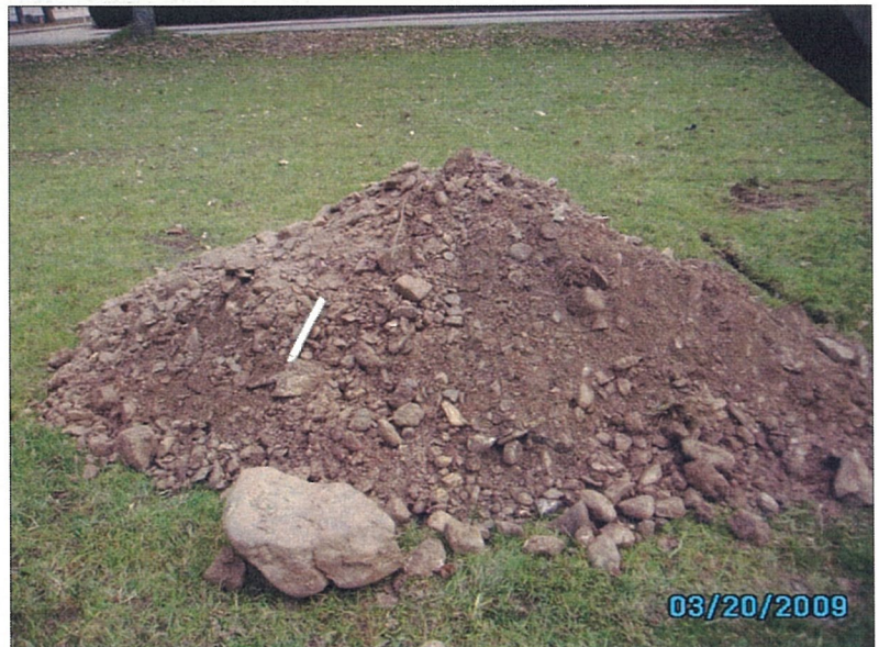
Abb. 3: Baggergut der den Bachschottern auflagernden Deckschichten
