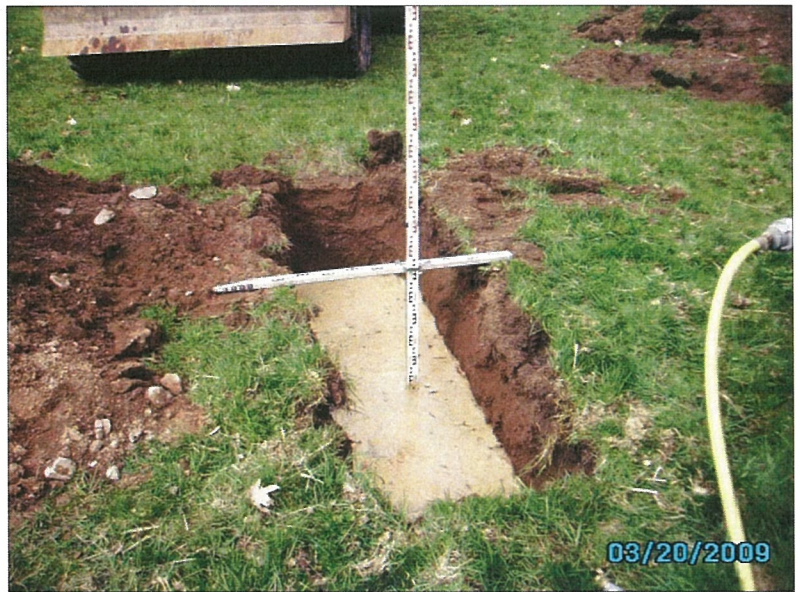
Abb. 15: Blick auf den Versickerungsversuch Vv2 am Ende des Versuchs. An den Schurfwänden deutlich erkennbar der durch einen Schaumrand gekenn- zeichnete, abgesunkene ursprüngliche Wasserspiegel
