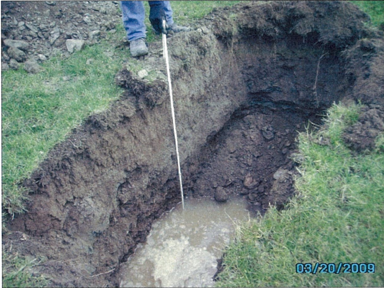
Abb. 2: kiesiges, teils steiniges Baggergut aus Schurf S1
