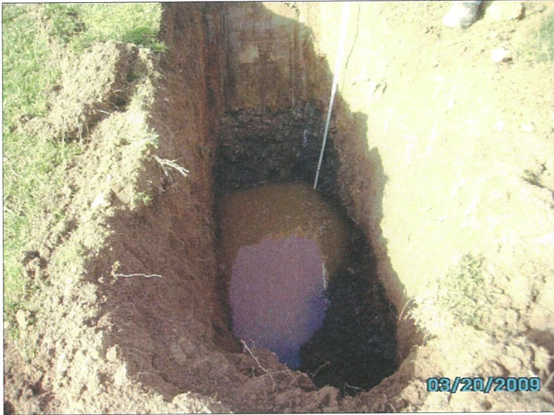
Abb. 5: Blick auf die Ansatzpunkte von Schurf S 2 und Versickerungsversuch VV 1
