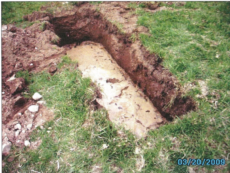
Abb. 15: Blick auf den Versickerungsversuch Vv2 am Ende des Versuchs. An den Schurfwänden deutlich erkennbar der durch einen Schaumrand gekenn- zeichnete, abgesunkene ursprüngliche Wasserspiegel
