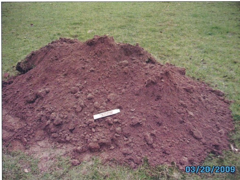
Abb. 3: Baggergut der den Bachschottern auflagernden Deckschichten
