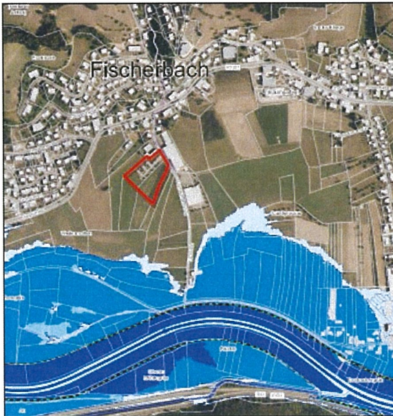
Hochwassergefahrenkarte; Quelle: LUBW
